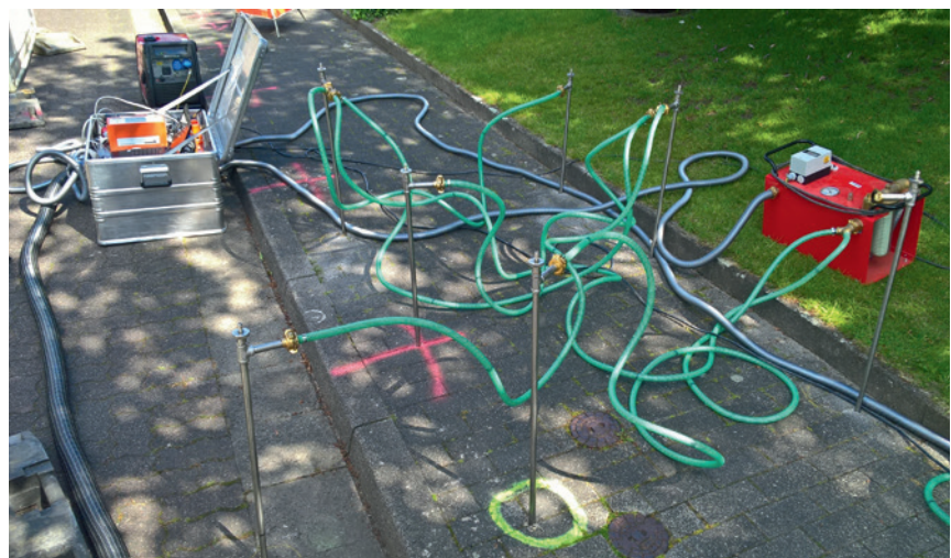
Abb. 2: Messung mittels Absaugmethode an einer erdverlegten Rohrleitung
